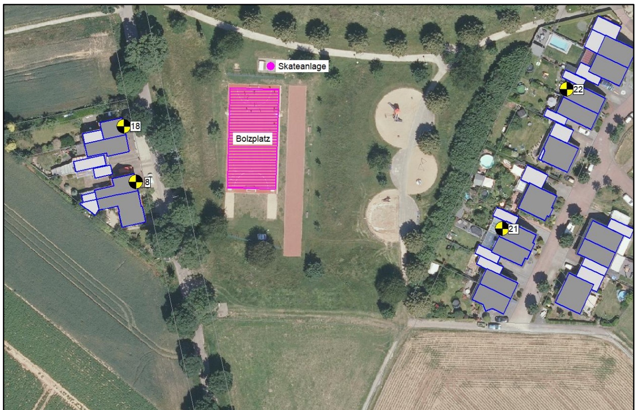
Abbildung 6: Auszug aus dem Berechnungsmodell für den Analysefall mit den relevanten Immissionsorten und Schallquellen nach 18. BImSchV [1]
